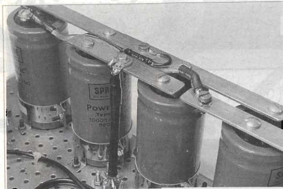
Un gruppo di elettrolitici di livellamento a cablaggio ultimato; notare il collegamento verso la massa (telaio metallico eseguito con un cavo da 8mm).
